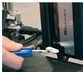
Sustitución rápida, fácil y más limpia del filtro del tubo de retorno
